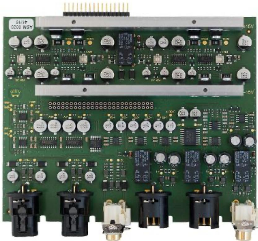
Die Platine mit der analogen Schaltung inklusive der Lautstärkeregelung und einer Line-Ausgangsstufe in Class A.
