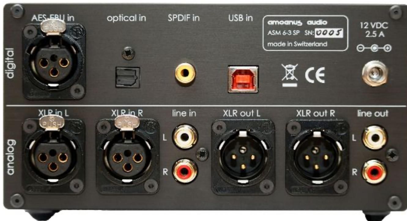
Auf der Rückseite finden sich vier digitale sowie zwei analoge Eingänge. Der symmetrische XLR-Ausgang ist variabel, der Line-out besitzt einen fixen Pegel.
